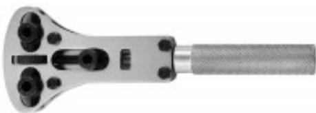
Der Gehäuseöffner eignet sich zum Öffnen von geschraubten Gehäuseböden, die am äußeren Rand in gleichmäßigen Abständen kleine Kerben eingearbeitet haben. Die separat verstellbaren Spannbacken lassen sich dort einsetzen um den Gehäuseboden bequem zu öffnen. Zusätzlich befindet sich in dem Werkzeugset ein kleines Döschen mit 18 verschiedenen Einsätzen.
