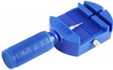
Der Stiftentferner mit Spindel oder auch einfach Armbandkürzer ist ein praktisches Hilfsmittel zum Kürzen von Metall-, Edelstahl-Holz- oder Kunststoffarmbändern. Das Armband wird in die Kerbe gelegt und der Stiftentferner wird mit Hilfe des Gewindes vorsichtig in die Öffnung für den Stift im Uhrenarmband geschoben. So lassen sich Uhrenarmbänder auf schonende Art und Weise kürzen.
