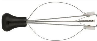
Ein Zeigerabheber ist unverzichtbar, wenn man Zeiger kratzerfrei vom Zeigerfutter entfernen möchte. Durch die Außenkanten, die aus Kunststoff bestehen, lassen sich Zeiger schonend entfernen und auch das Zifferblatt bleibt unbeschädigt.
